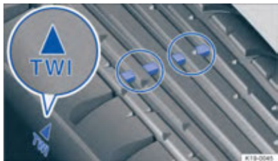
تصویر ۱۶۹: آج لاستیک: نشانه‌های سایش (تصویر)
