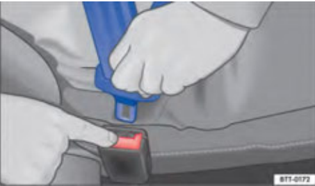
تصویر ۲۷: آزاد کردن زبانه قفل از قفل کمربند ایمنی
