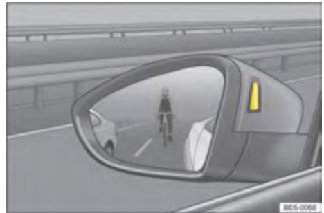
تصویر ۱۰۸: روی بدنه آینه‌های بغل خودرو: نمایش بصری سیستم هشدار خروج از خودرو
