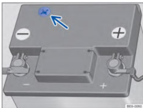
تصویر ۱۶۵: سوراخ مشاهده باتری در بالای باتری ۱۲ ولت خودرو (تصویر)
