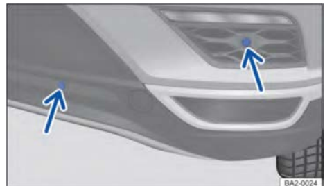
تصویر ۱۳۱ روی سپر عقب: سنسورهای اولتراسونیک سیستم هشدار فاصله پارک هنگام دنده عقب
