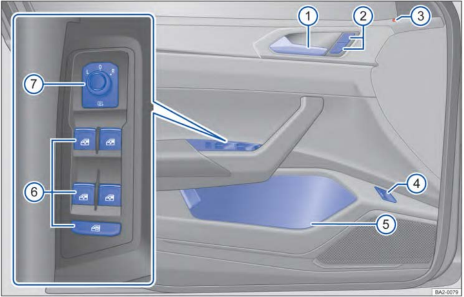
تصویر ۶ نمای کلی از مکانیسم عملکرد درب راننده
