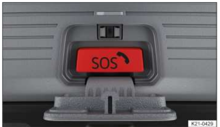
شکل 2 در کنسول سقف: دکمه برای خدمات تماس اضطراری.
