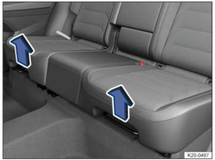
شکل 1 زیر بالشتک صندلی عقب: اهرم تنظیم (تصویر).
