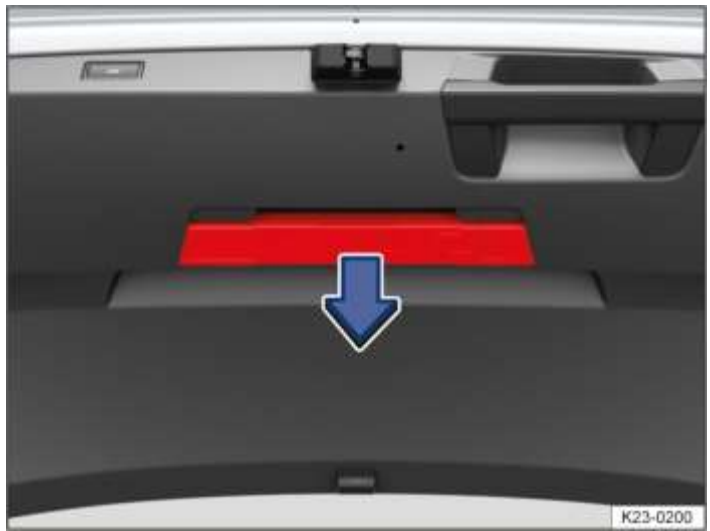
شکل 1 در درب صندوق عقب: نگهدارنده مثلث هشدار دهنده.
