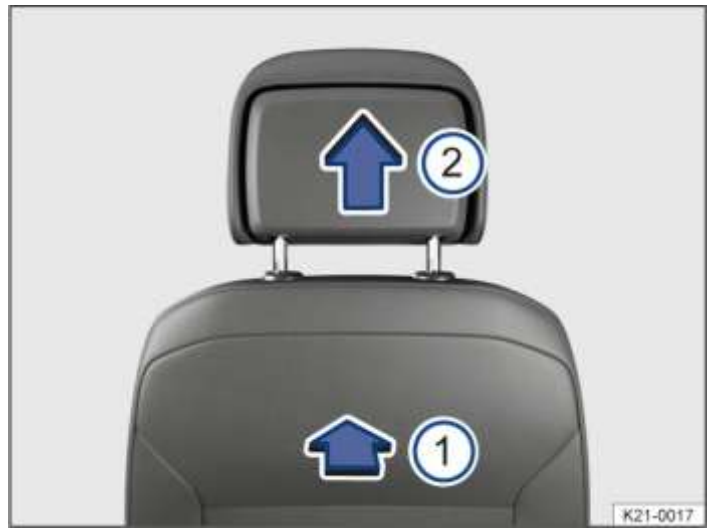
شکل 2 برداشتن تکیه گاه سر جلو (تصویر).
