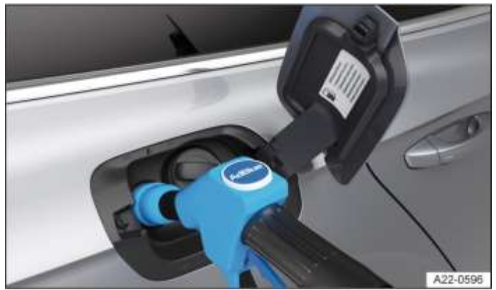
شکل 2 پشت دریچه مخزن: AdBlue را دوباره پر کنید با استفاده از نازل (تصویر).
