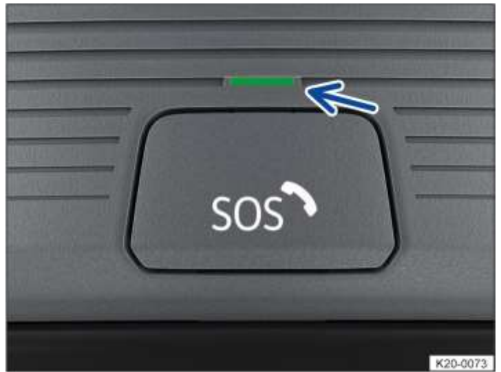
شکل 1 در کنسول سقف: دکمه برای تماس اضطراری سرویس (پشت جلد دکمه) و چراغ نشانگر.
