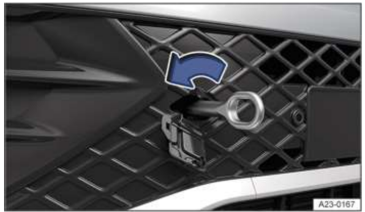
شکل 4 در سپر جلو در سمت راست: پیچ کردن درچشم بکسل، نوع 2.
