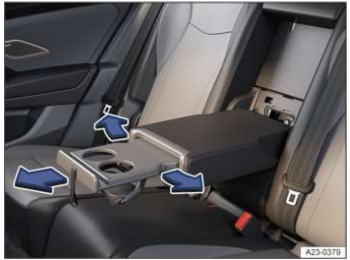
شکل 2 در تکیه گاه بازو وسط عقب: سیستم ذخیره سازی بیرون کش (تصویر).
