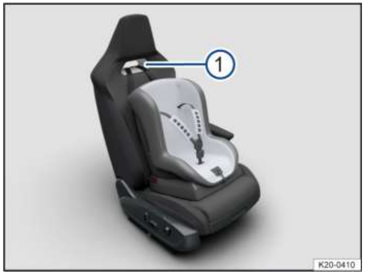
شکل 4 در قسمت پشتی صندلی اسپرت (یا بازشو) در سمت سرنشین جلو؛ اتصال بالا (تصویر).
