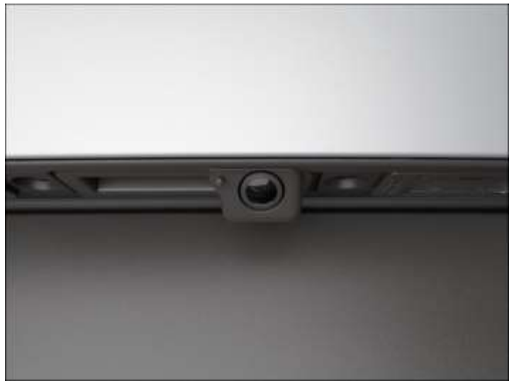
شکل 2 در عقب خودرو: سیستم دوربین دید عقب روی دکمه دسته (تصویر).
