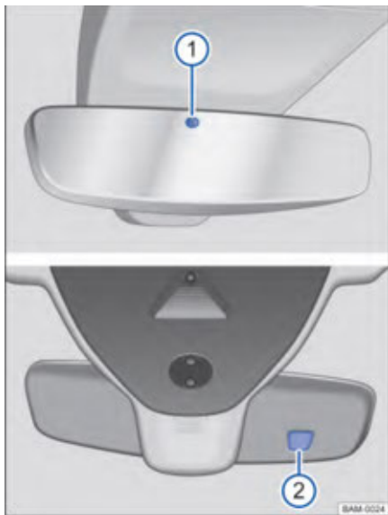
تصویر ۸۶: روی شیشه جلو: آینه دید عقب با تنظیم انعکاس نور
