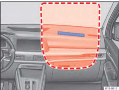
تصویر ۳۲: محل نصب و محدوده عملکرد کیسه هوای سرنشین جلو
