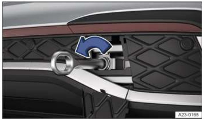
شکل 4 در سپر عقب در سمت راست: پیچ کردن در چشم بکسل
