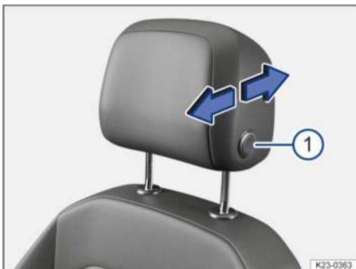
شکل 2 تنظیم یک تکیه گاه سر جلو با طولی تسهیلات تنظیم (تصویر).
