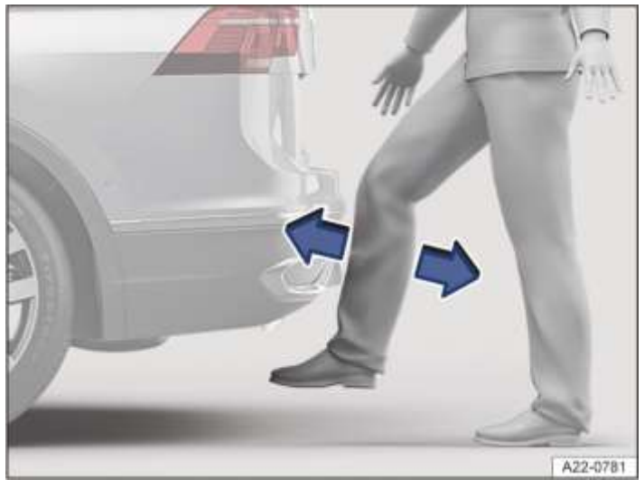
شکل 1 تصویر درب صندوق عقب با بسته شدن کنترل شده توسط حسگر (Easy Close).
