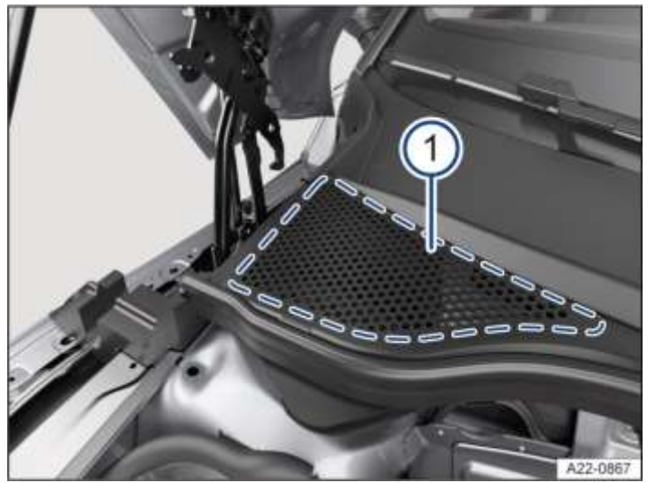
شکل 1 بین فضای کاپوت و شیشه جلو: اتاق پلنوم (تصویر).
