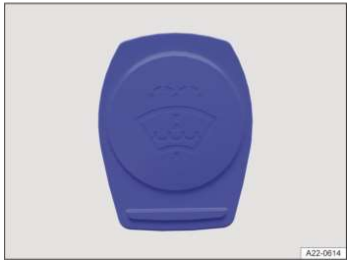
شکل 1 در فضای کاپوت؛ درپوش مخزن مایع شیشه شوی (تصویر).
